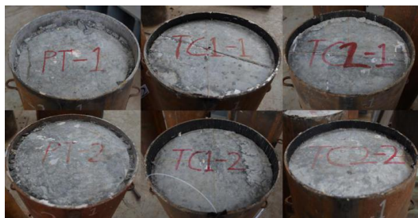
图 4 推出试件破坏形态
